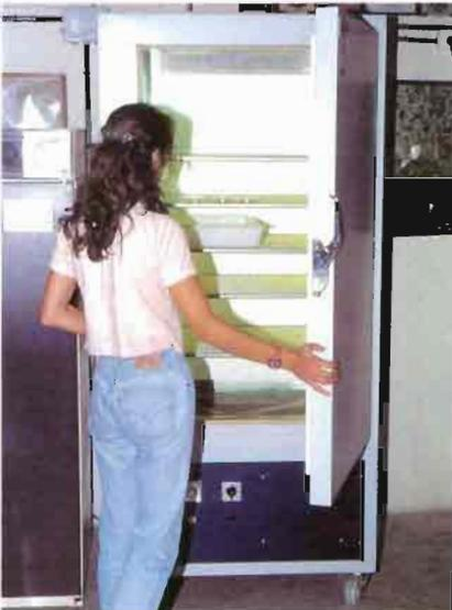
Fig. 2.- Cámara de incubación con control de iluminación y temperatura, utilizada para ensayos de germinación.
